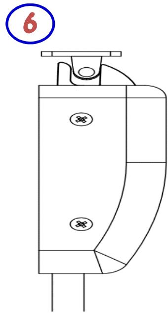
برای نصب بدنه پایینی نیز ابتدا کاور روی آن باز شده و با چهار پیچ مشخص شده در پایین به روی درب در فاصله مناسب از پایین و بغل نصب گردد. در این قسمت نیز باید بدنه پایینی در امتداد لوله اتصال قرار گیرد تا عملکرد دستگیره دچار مشکل نگردد.
